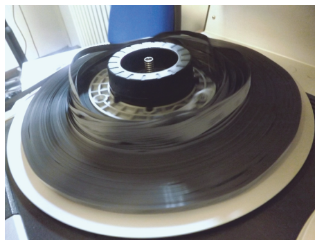
Figura 1 - Esempio di bobina soggetta a cattivo avvolgimento
